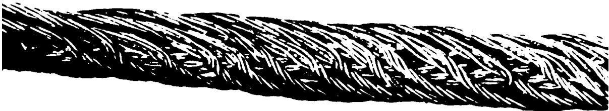
Ilustração 19 - Achatamento de um cabo composto de diversas pernas, causado pelo enrolamento incorreto no tambor
