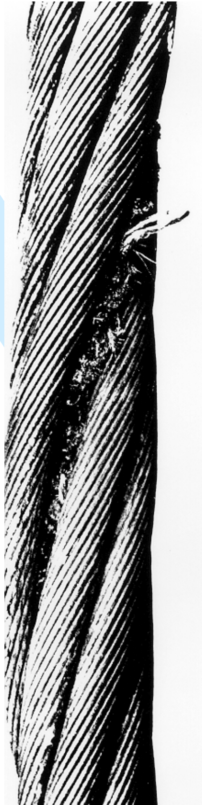
Ilustração 14 - Aumento local no diâmetro do cabo, devido à saliência da alma de fibra, em uma condição degradada entre as pernas externas
