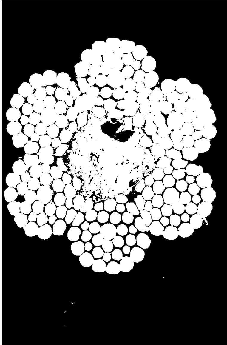
Ilustração 7 - Um exemplo de corrosão interna acentuada
